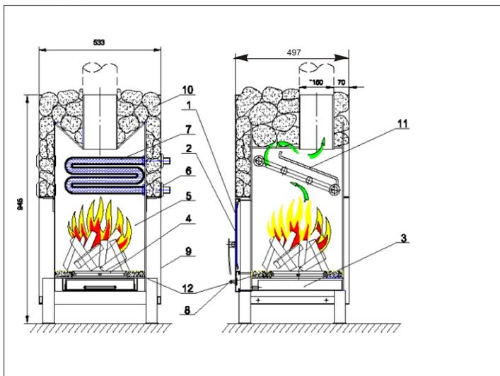
**Рис.1.** 1.Дверцы. 2. Стекло. 3. Ящик для пепла. 4. Колосник. 5. Очаг топки. 6. Крышка. 7. Теплообменник. 8. Заслонка на подаче воздуха. 9. Отделочные щиты. 10. Камни. 11. Рассекатель огня. 12. Вермикулит.
